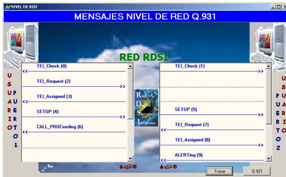
Figura 1: Captura de la secuencia de tramas a nivel de red con el PAW (I)
